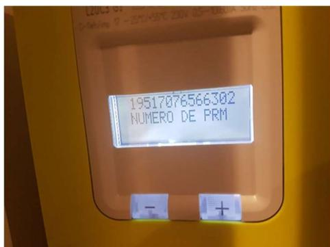
Si le courant saute, il suffit de rester appuyer 10 secondes sur le bouton « + » du compteur Linky représenté ci-dessus.
